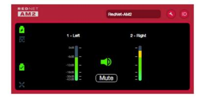
La ilustración anterior muestra un RedNet AM2 con Line Out Mute inactivo y muestra la señal presente en ambos canales. Tiene alimentación PoE disponible y tiene una conexión de red bloqueada.
